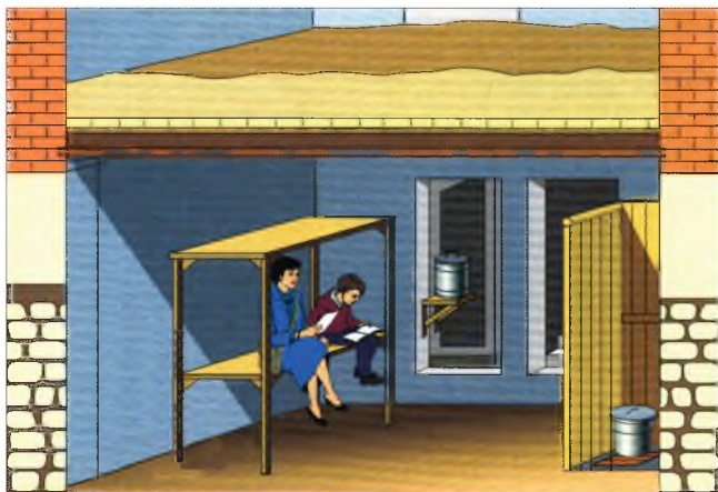
Рис. 4 — Подвал, приспособленный под укрытие
